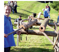
17 Düchel bohre Stamm durchbohren
